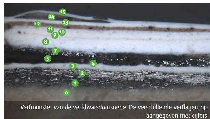
Verfmonster van de verfdwarsdoorsnede. Door een speciale filter zijn glimmende delen zoals metalen zichtbaar. Op de zilverkleurige laag zitten behoorlijk wat vuildeeltjes.
