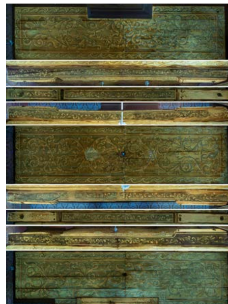
Op de UV-fluorescentieopname zijn blauwe verkleuringen te zien rond het raam waarschijnlijk door binnenvallend zonlicht (foto René Gerritsen).
