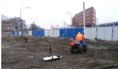
Afb. 64-65 Grondradar-onderzoek: de tracer wordt achter een quad gesleept met er bovenop de GPS-antenne; beide zijn verbonden met een laptop achterop de quad die alle informatie opslaat
