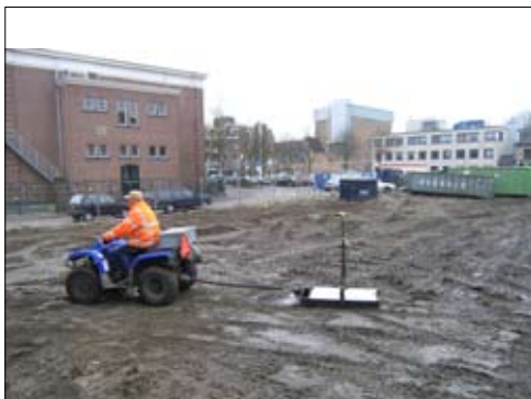
Afb. 17 Grondradaronderzoek met de quad
