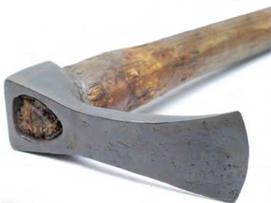
Een smeedijzeren dissel met lange houten steel, voor grove houtbewerking bijvoorbeeld door een huistimmerman, gevonden in een 16de-eeuwse waterput (10PAA1114).
