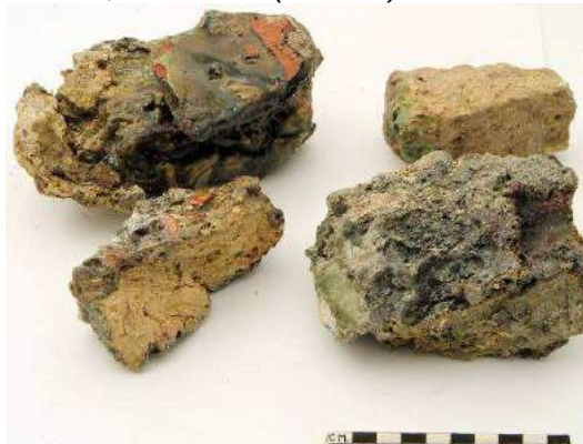
Afb.53 Als ovenproenen gebruikte dakpannen, met rode en witte aanbaksels door lekkend glazuur; Afb.54 verbrokkelde bakstenen van het ovenrooster (09LAA9)
