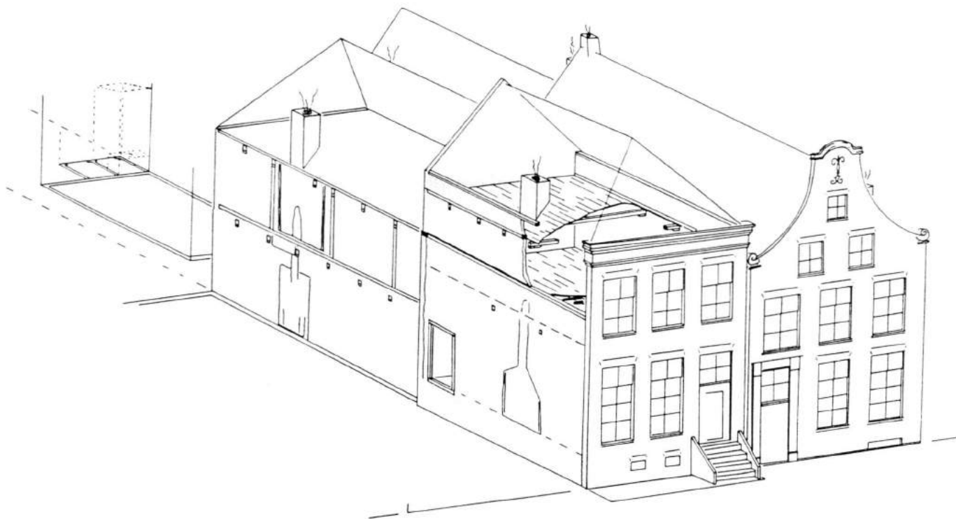
Boven: Langestraat 113/115/117: bouwhistorische reconstructie van het pand rond 1900. Onder: Langestraat 115/117 voor verbouwing 1913.
